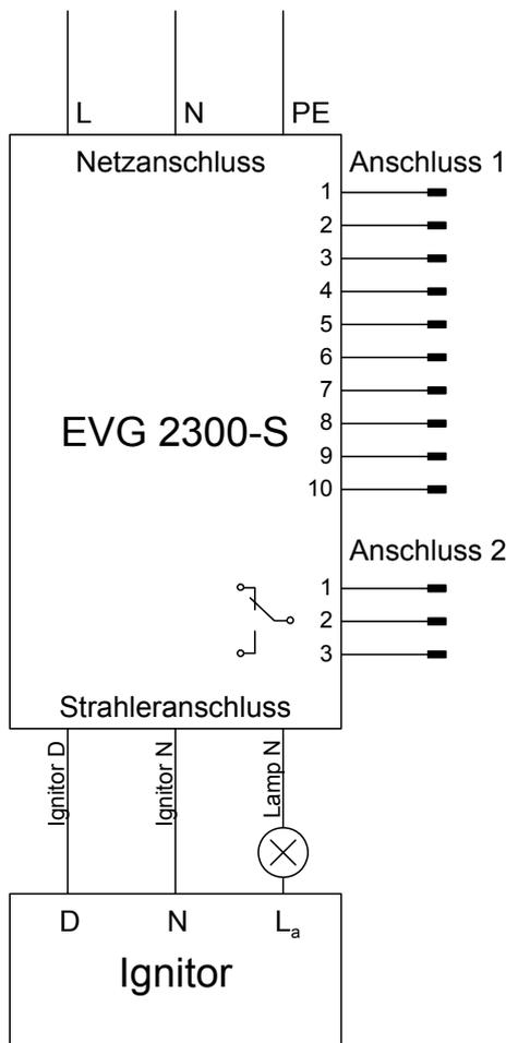
Ignitor N wird nach 10s abgeschaltet
